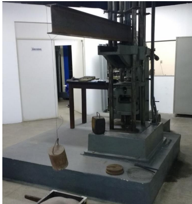
Figura 4. Condições de apoio da viga em balanço
