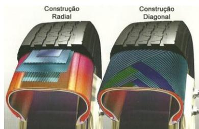
Figura 2 – Construção de Pneus
