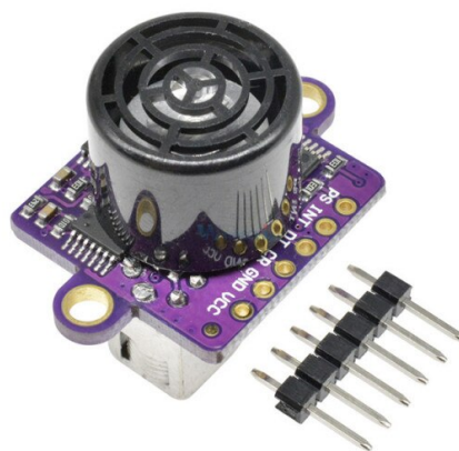
Figura 6 - Sensor ultrassônico GY-US42v2 utilizado no projeto.
