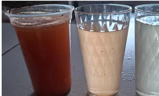
Figura 20 - Resultado da filtragem da água com folhas
