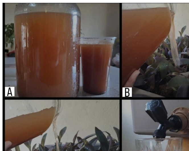
Figura 19 - Etapas Filtragem Água com Terra Vermelha (A); despejando sobre a macrófita (B) e (C) e resultado da filtragem(D).
