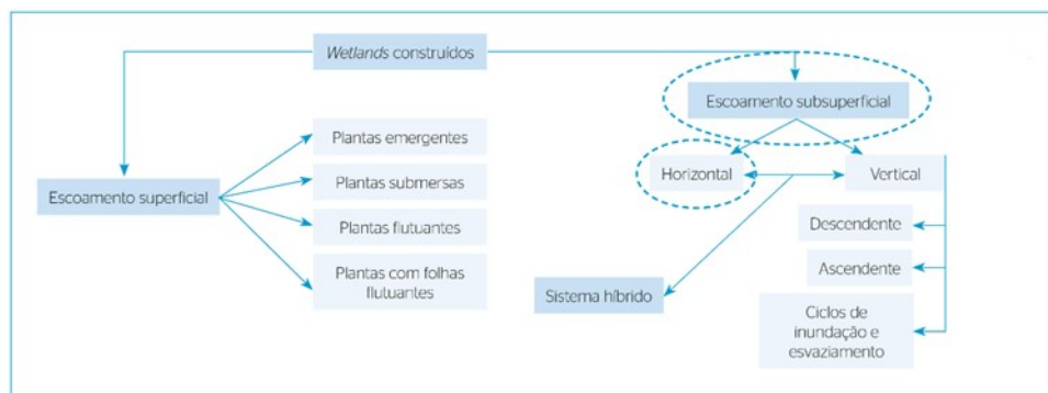
Foto 1 - Classificação dos Wetlands Construídos
