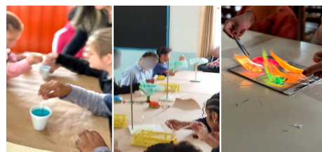
Figura 1. A) Imersão de um clipe galvanizado em uma solução de sulfato de cobre; B) Separação da proteína do leite através do processo de filtração e; C) Experimento do fogo colorido.
