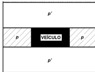
Fig. 5 Live load configuration – Classe 36
