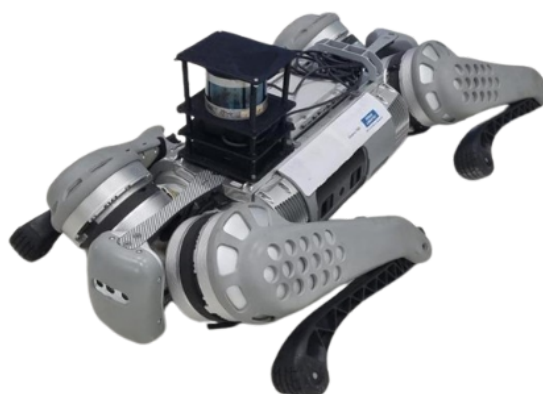
Figura 3: LiDAR 3D acoplado ao quadrúpede B1.
