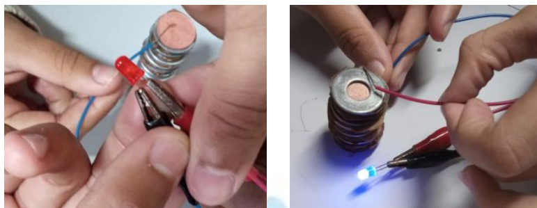
Figura 1 – Montagem e acendimento do LED.
