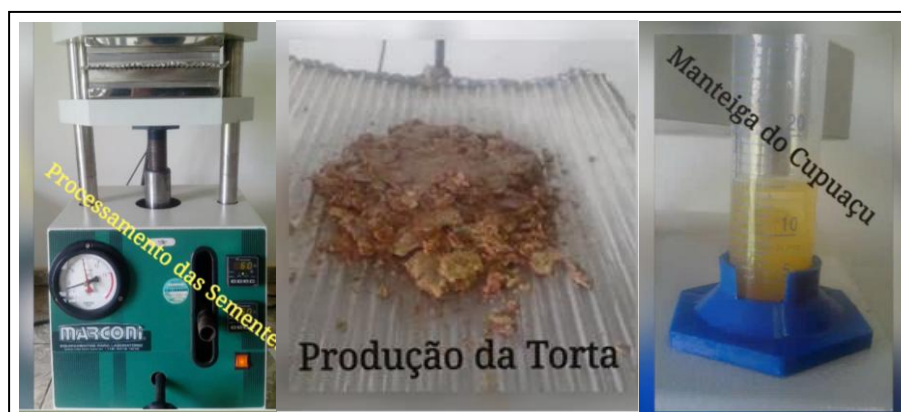
Figura 5: Sistema de Processamento adaptado para obtenção da torta e manteiga das sementes do cupuaçu no LR da Embrapa Roraima. Imagens: Ribeiro (2017).
