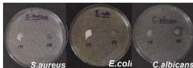
Figura 3. Placas de microcultivo com as amostras eletrofiadas de AC, na ausência (1) e presença (2) de NPs de Ag, sintetizadas em meio aquoso.
