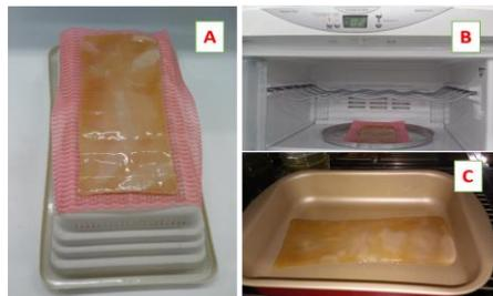
**Figura 1.** Condições de secagem para os polímeros. 1A (Temperatura de secagem: 25°C), 1B (Temperatura de secagem: -2°C), e 1C (Temperatura de secagem: 60°C).
