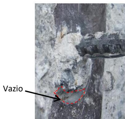
**Figura 13. Região do furo (Protótipo D60T12R16-C2).**
