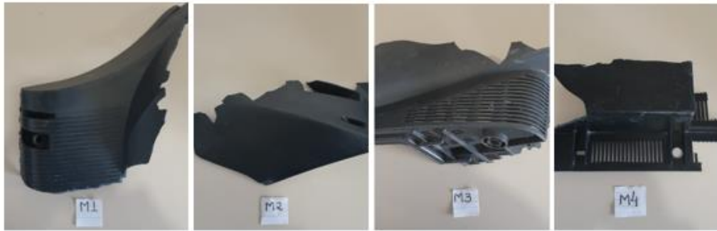
Figura 1 – Resíduos poliméricos oriundos de carcaças de diferentes televisores
