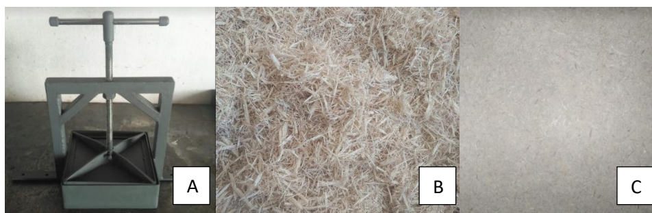
Figura 1: Em A vemos a prensa manual desenvolvida; em B observa-se as partículas randômicas; em C observa-se a placa após prensagem e cura.
