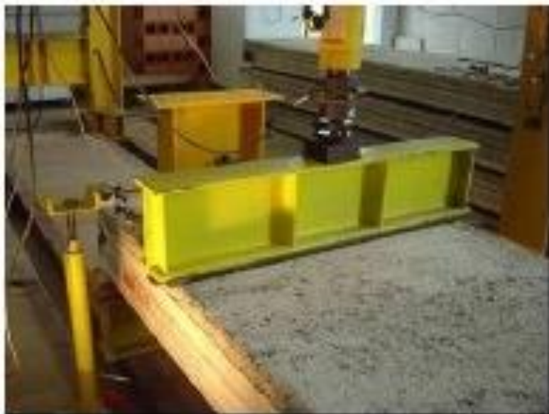
Figura 3 – Posicionamento da viga de transferência de força no ensaio. (Catoia, 2011)
