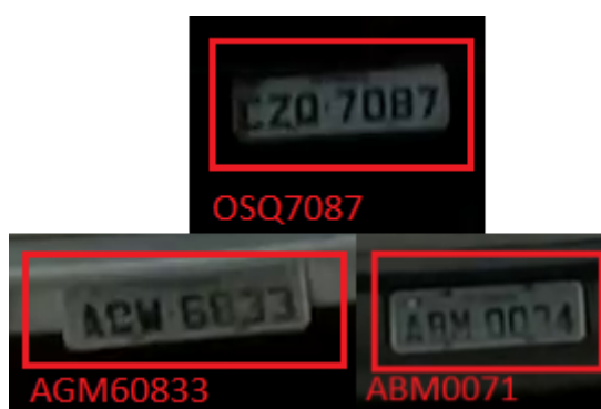
Figura 5. Exemplos de detecção da placa e extração dos caracteres com error.
