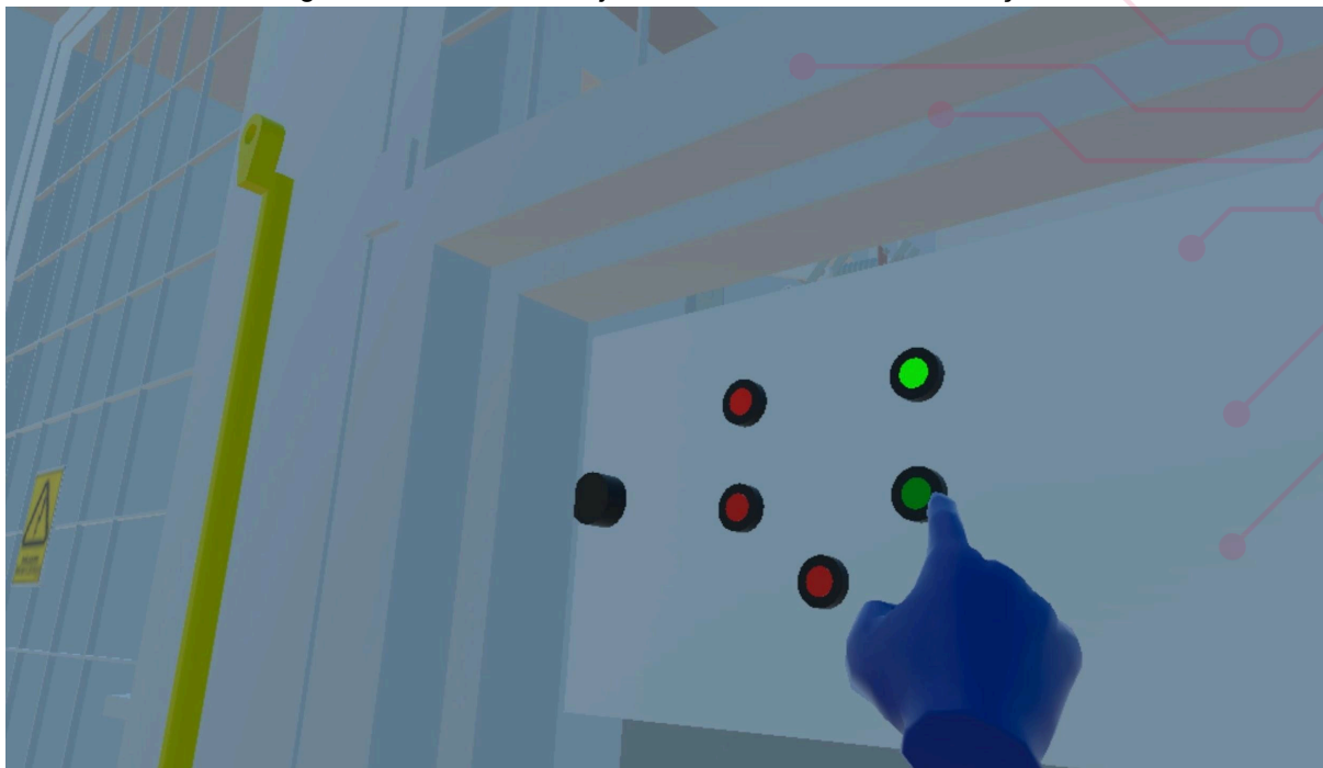
Figura 2: Manobra de disjuntor no simulador de subestação.
