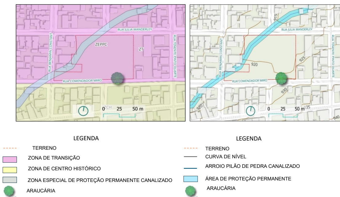
Figura 4 – Análise de Condicionantes Físicas e Legais do Terreno.
