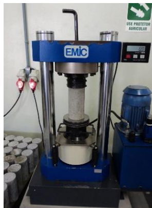
Foto 11: Ensaio de Resistência de Compressão do Concreto
