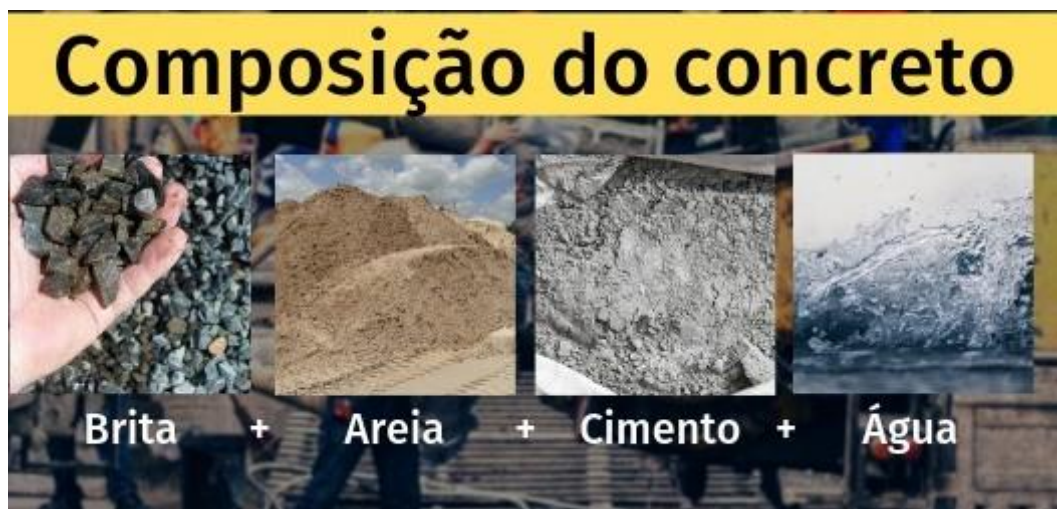
Foto 10: Composição do Concreto
