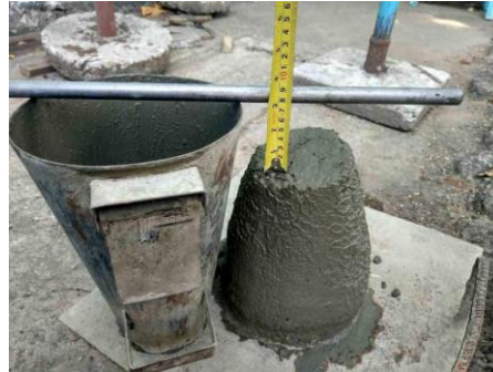
Foto 12: Controle concreto – Slump Test
