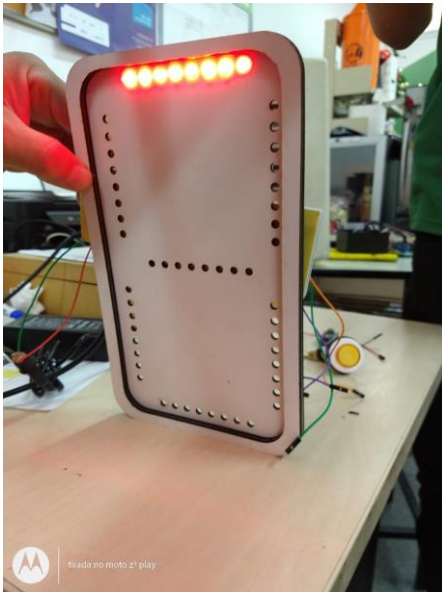
Figura 12 – Protótipo em teste de bancada – Display com acrílico
