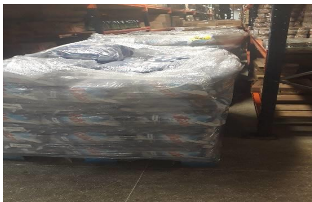
Figura 5 - Acúmulo de produtos nos corredores dificultando o tráfego das empilhadeiras Fonte: Dados da pesquisa
