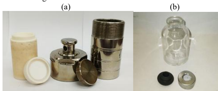
Figura 1: Fotografia (a) de um reator solvotérmico comercial e (b) do reator solvotérmico de baixo custo adaptado.
