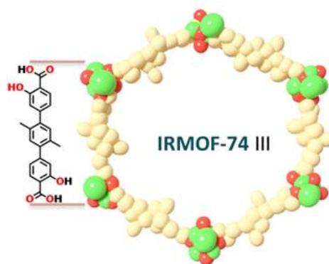
Figura 2: Estrutura molecular do LINKER III e estrutura tridimensional do poro das IRMOF-74.
