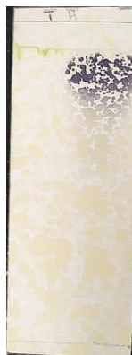
Figura 3 – Teste taninos: à esquerda banda da amostra e à direita banda do padrão ácido gálico.
