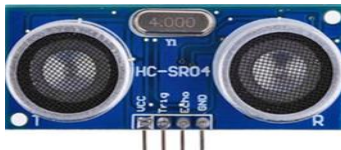
Figura 5 - Sensor Ultrassônico que será utilizado no projeto
