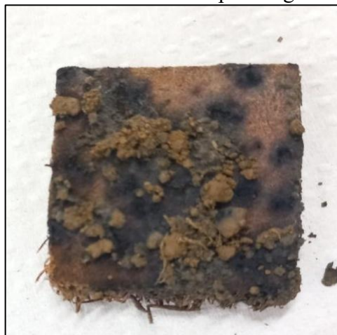
Figura 1 - Corpo de prova de eucalipto com manchas causadas por fungos.
