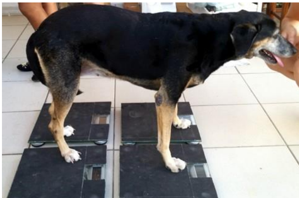
Figura 1: Utilização de 4 balanças com superfície antiderrapante organizadas no piso de forma que, com o animal em estação, cada pata apoiasse em uma balança (fonte autoral).
