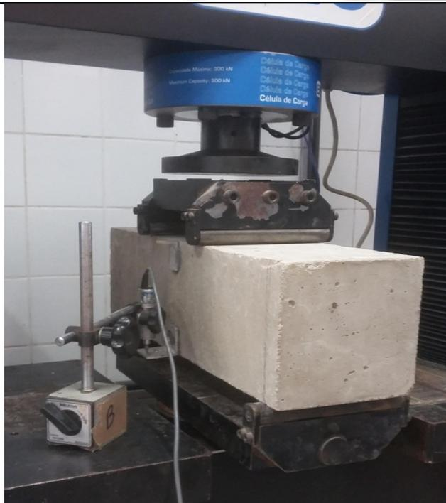
**Figura 8. Instrumentação da viga com o LVDT**
