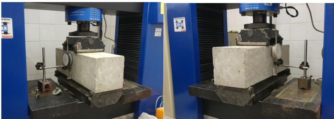
Figura 7. Instrumentação da viga com os relógios comparadores
