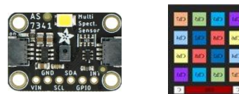
Figura 2. Sensor AS7341 e representação esquemática do conjunto de fotodiodos do detector
