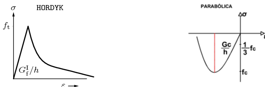
Figura 6 - (a) Modelo com amolecimento linear na tração e (b) modelo parabólico na compressão para representar o concreto Fonte: (TNO, 2011)
