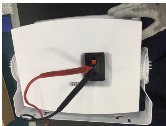
Figura 3. Aquisição do sinal do Woofers e do Tweeter a partir do borne da caixa acústica.
