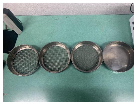
Figura 2: Peneira de fezes com granulometria, da esquerda para a direita, de 4,75 mm (P1), 3,15 mm (P2) e 1,60 mm (P3) (Fonte: Cedido por Magalhães, 2023).
