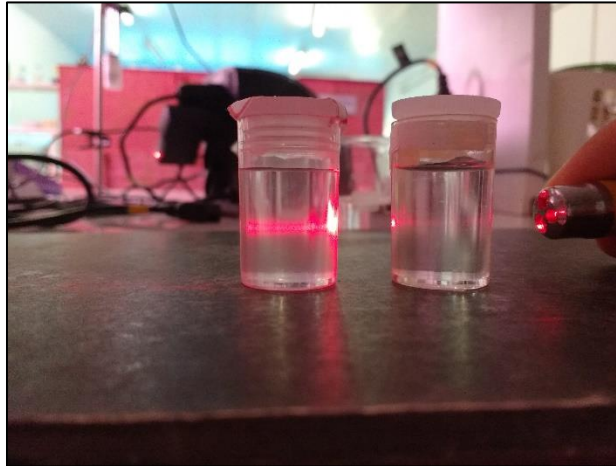
Figura 2- Dispersão da luz na suspensão de SNP de fruta-pão (esquerda) e em água destilada (direita).
