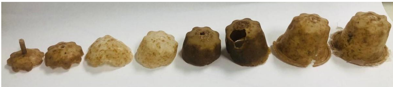
Figura 2. Peças extraídas ao longo da injeção.
