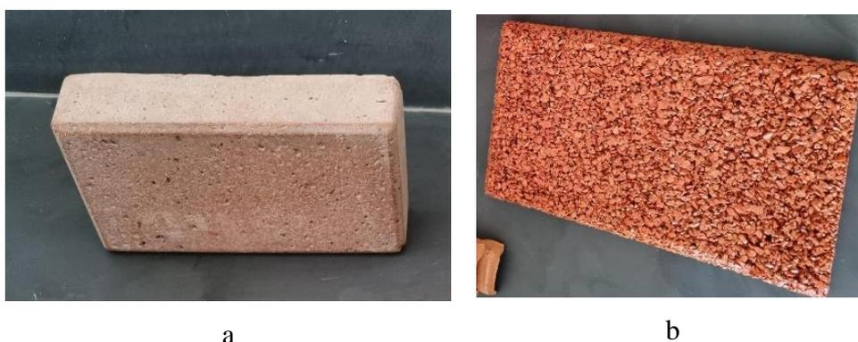
Figura 2. Material para a confecção das portas dos fornos gerado a partir da mistura de cinzas e argila (a) e protótipo de piso permeável gerado a partir de resíduos de telhas e tijolos (b).
