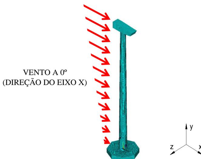
**Figura 5 - Direção de aplicação da força proveniente do vento não determinístico**
