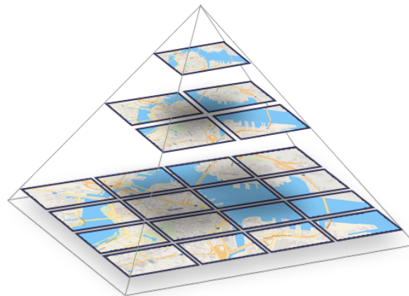
Figura 2 - Esquema explicativo de raster tiling
