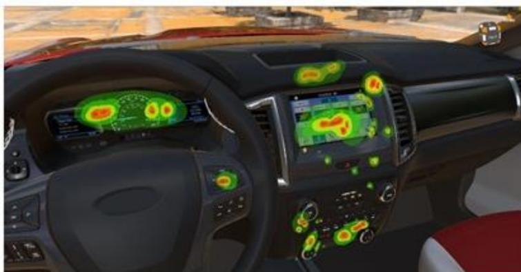
Figura 1: Painel de automóvel com heatmap em realidade virtual.
