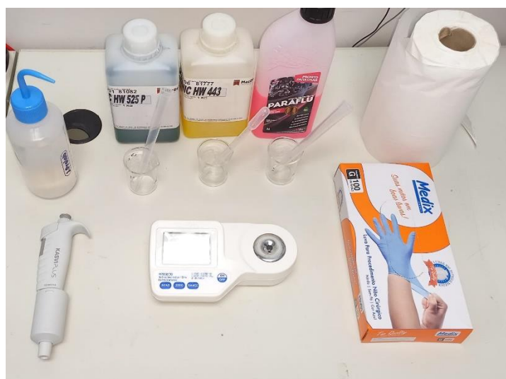
Figura 1: Imagem da bancada de teste utilizada para medidas de índice de refração.
