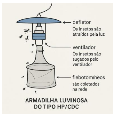
Figura 1. Armadilhas luminosas dos tipos HP e CDC. Imagem representativa das armadilhas utilizadas para a captura de flebotomíneos durante o período noturno, as quais se baseiam na atração dos insetos pela luz e na sucção gerada por um pequeno motor (Feito por IA).
