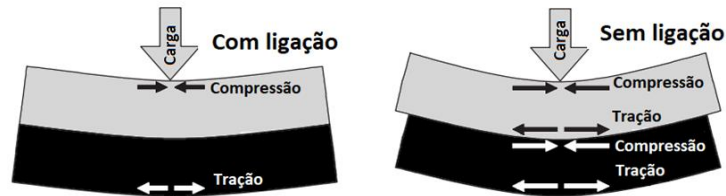
Figura 1: Comportamento do pavimento sob carga vertical - Fonte: [8]
