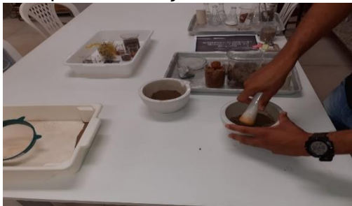
Figura 1: Maceragem dos solos para confecção das tintas
