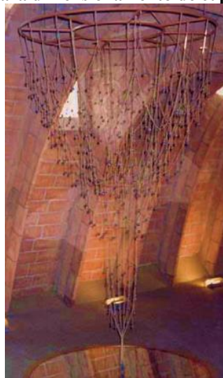
Figura 7 – Modelo de Gaudí para dimensionamento de cúpulas pela analogia de correntes
