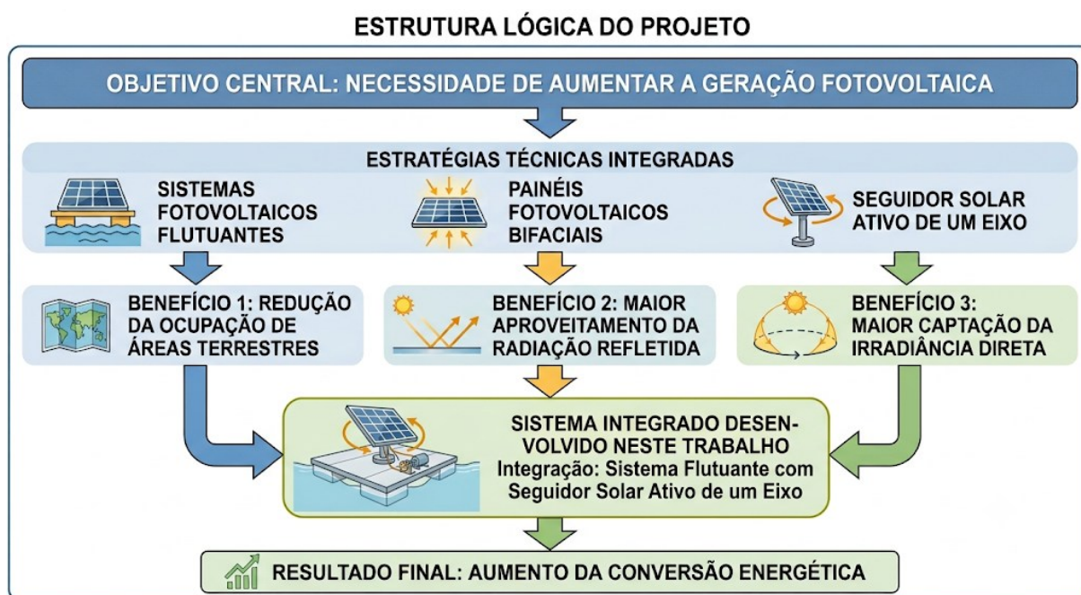
Figura 1 – Arquitetura conceitual do sistema flutuante, módulos bifaciais e seguidor solar ativo.
