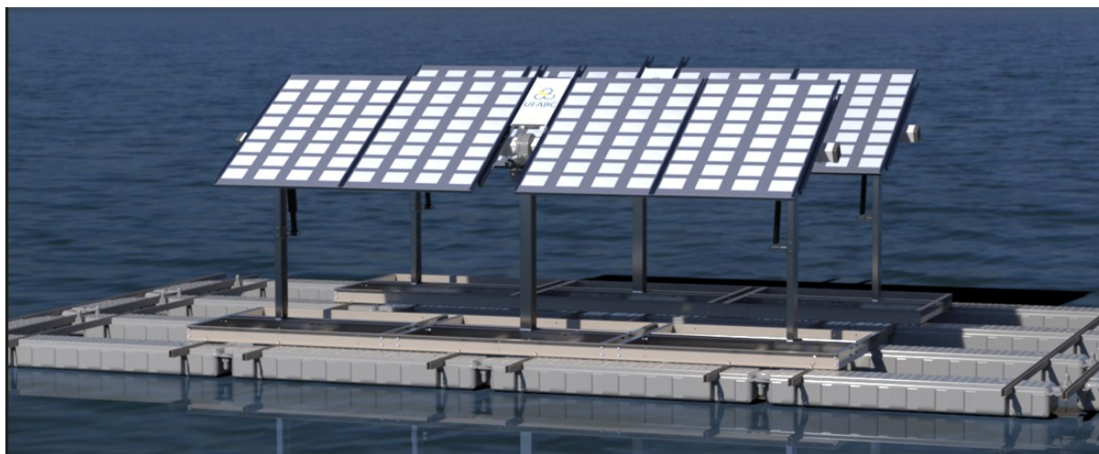
Figura 5 – Renderização sistema Flutuante com seguidor solar
