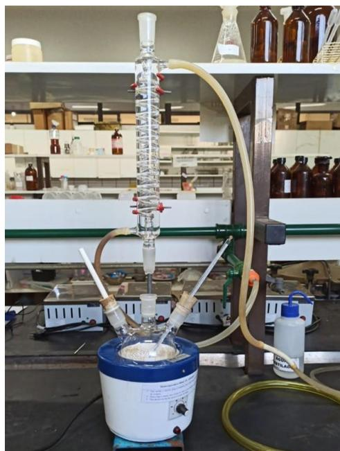
**Figura 1** – Sistema de hidrólise ácida da polpa de baru.
