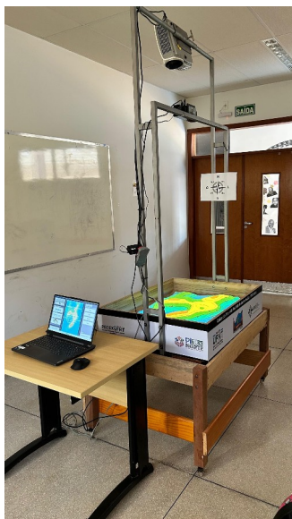
Figura 1 – Estrutura da Caixa de Areia de Realidade Aumentada do CEHS
