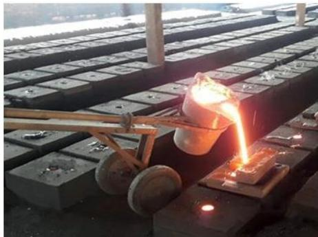
Figura 3 e 4. A função dos moldes de areia. Fonte: Fundição de metais: entenda melhor o processo (engenharia360.com). Consulta em 10/08/2022
