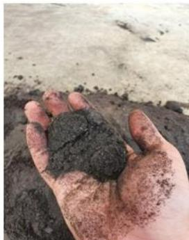
Figura 2. Areia de fundição utilizada nos experimentos para o presente artigo. Fonte: fotografia autoral.
