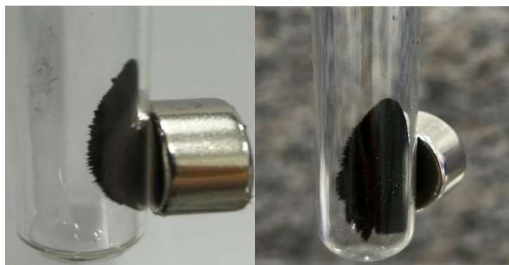
Figura 1: Nanopartículas de \text{Fe}_3\text{O}_4 sintetizadas pelas rota 1 (à esquerda) e rota 2 (à direita) sob efeito do campo magnético externo (ímã)
