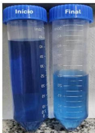
Figura 4: Comparação visual da solução no início e após o processo de adsorção do corante índigo carmim pelas NP-Fe 3 O 4 sintetizadas pela rota 2
