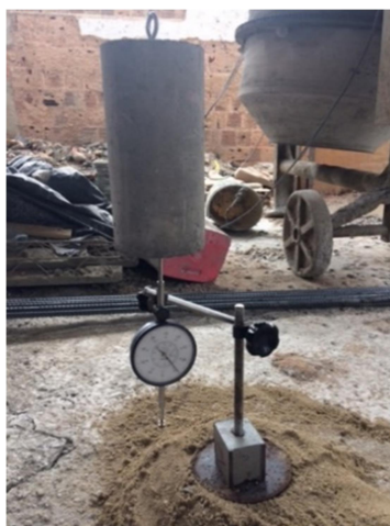
Figura 05 – Relógio comparador em base magnética apoiada em maciço de areia
