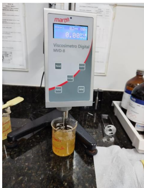
Figura 07: Teste de viscosidade sendo feita no viscosímetro Brookfield
