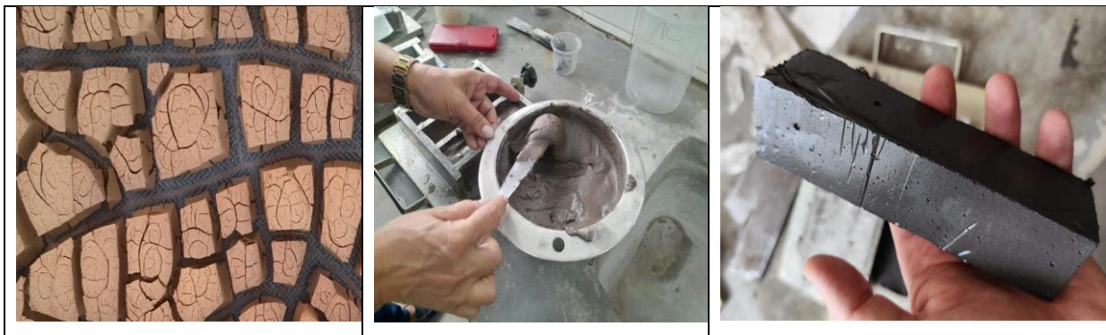
Figura 2: Etapas de produção de AAA com lodo de ETA
